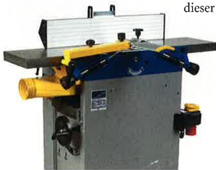
Die Höhenverstellung des Abgabetisches erfolgt seitlich an der Klappachse
